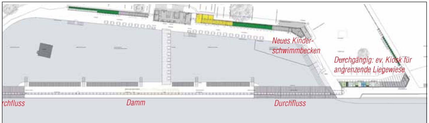
Vorprojekt: Der Steg wird erneuert. In der Mitte wird der Unterbau erhalten, nördlich und südlich des Bades kann das Wasser durch eine lamellenförmige Konstruktion fliessen. Die Strömung im Bad wird durch die Öffnung leicht zunehmen. Garderoben und Duschen im südlichen Teil werden umgebaut und eventuell ein Kiosk für die Badegäste der Liegewiese eingerichtet.
